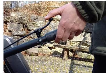
**Rechts** befinden sich die **Bremse** und das **Gas**.
